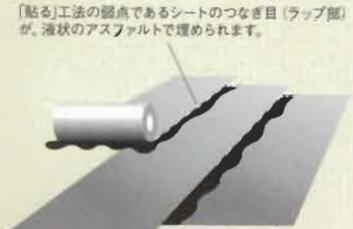
「貼る」工法の弱点であるシートのつなぎ目（ラップ部）が、液状のアスファルトで埋められます。
